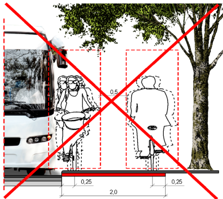
Błędne rozwiązanie - dwukierunkowa droga dla rowerów bez zachowania skrajni od jezdni.
