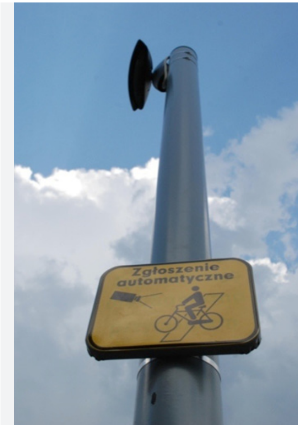
ZDJĘCIE 48. Łódź. Detekcja optyczna przed przejazdem dla rowerzystów.
